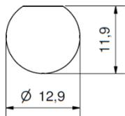
Montagedurchbruch ohne Isolierdurchführung
