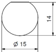
Montagedurchbruch mit Isolierdurchführung
