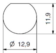
Montagedurchbruch mit Isolierdurchführung
