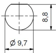
Montagedurchbruch ohne Isolierdurchführung
