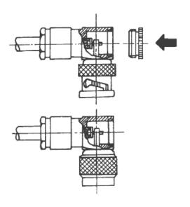
Kabel so weit wie möglich in Steckeranschluss eindrücken und Druckschraube fest anziehen. Überschüssiges Lot entfernen. Verschlussschraube fest verschrauben.
