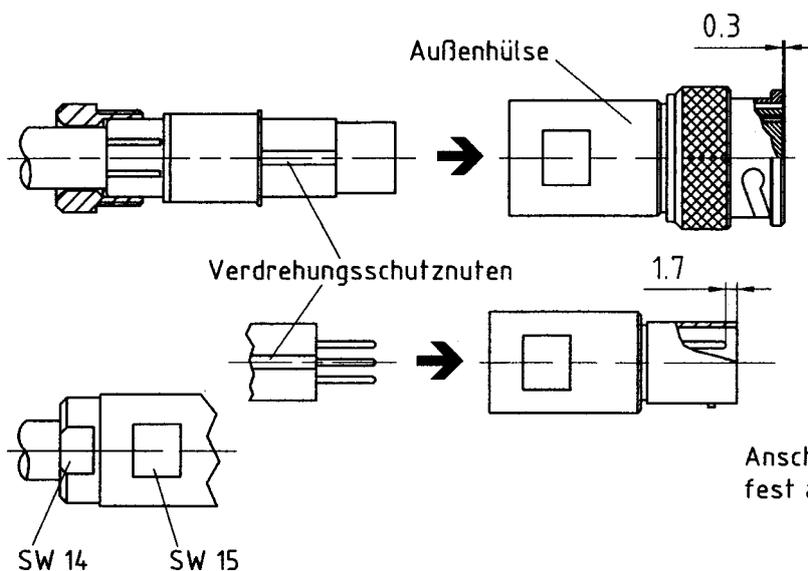
Einzelteile zusammenschieben und in Außenhülse einführen. Dabei die Lage der Verdrehungsschutznuten beachten.
