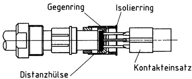
Leitungsenden kurzzeitig verzinnen. Gegenring, Distanzhülse und Isoliering auf das Kabel schieben und Leitungsenden am Kontakteinsatz anlöten.
