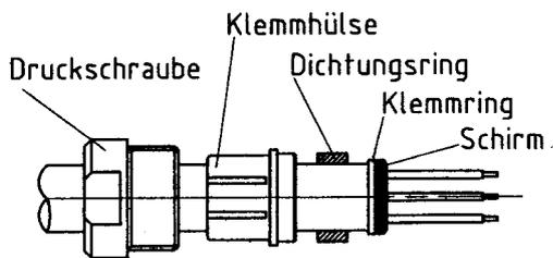
Druckschraube, Klemmhülse, Dichtungsring, Klemmring auf das Kabel schieben (Klemmring nur bis zum Kabelmantel) und Abschirmgeflecht über Klemmring zurückbiegen und einkürzen.
