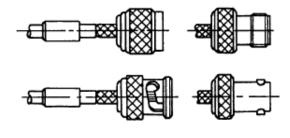
Kabel in Stecker- bzw. Buchsenanschluss einführen, bis Kontaktstift bzw. Kontaktbuchse fühlbar einrastet. Anschließend Crimphülse über Abschirmgeflecht vorschieben.
