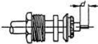
Druckschraube, Dichtungsring und Klemmring auf das Kabel schieben (Klemmring nur bis zum Kabelmantel) und Abschirmgeflecht über Klemmring zurückbiegen. Maß „d“ kontrollieren, gegebenenfalls Dielektrikum zurückschneiden.
