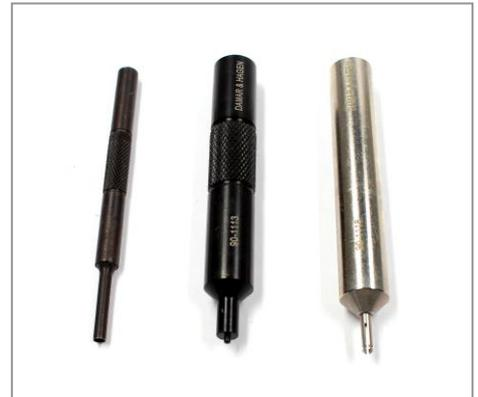
Montagesatz: ① Lösedorn ② Einspressdorn ③ Ausziehdom
