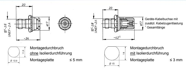
Innenleiter - Lötanschluss Außenleiter - Klemmanschluss
